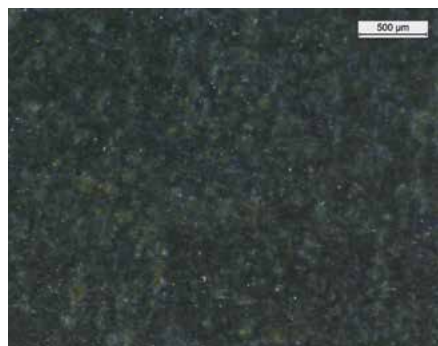
Keine kleinen Poren in der Oberfläche sichtbar
