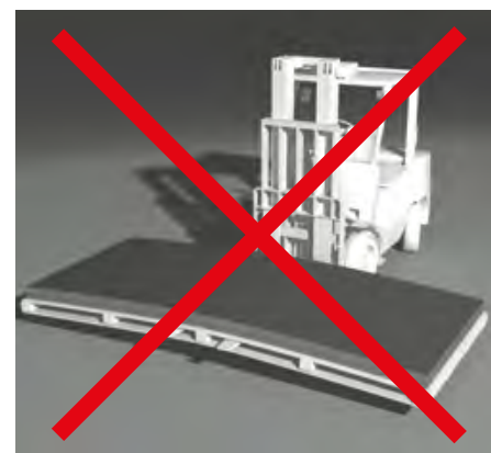
Nesprávná přeprava vysokozdvíhacím vozíkem Obrázek 45
