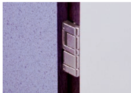
ZAWIAS OBIEKTOWY (FIRMA PRÁMETA) DO DRZWICZEK Z PŁYT COMPACT GRUBOŚĆ DRZWICZEK 10 - 13 MM. OTWIERANIE JEDNOOSIOWE.
