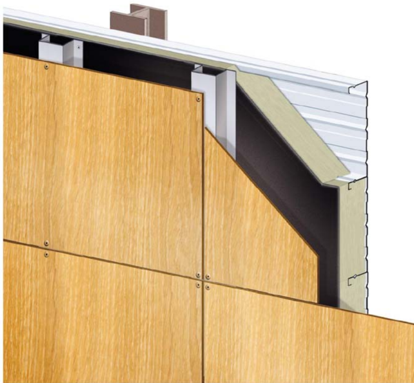
Figure 2 – Schéma de principe panneaux avec pare-pluie synthétique
