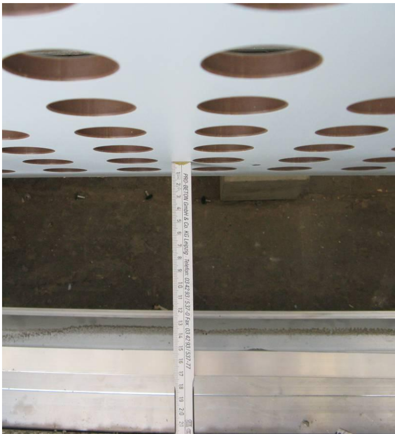
Bild 6: Öffnungen von >120 mm an Versuchskörper 1-1
