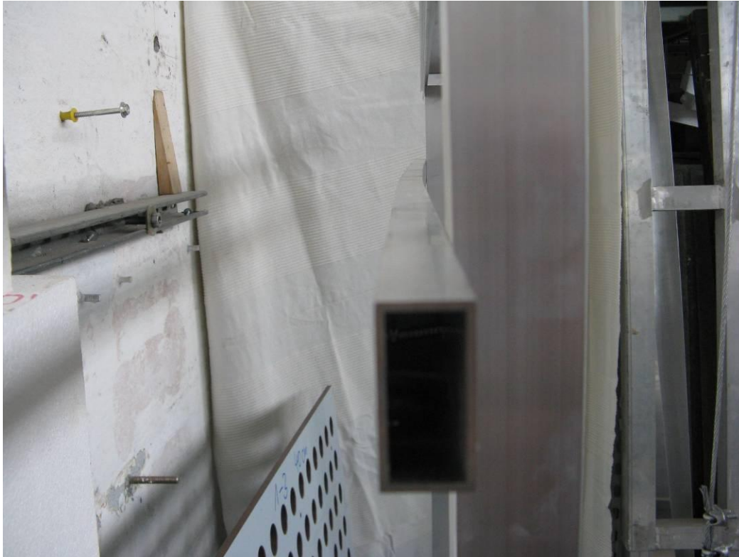
Bild 11: plastische Profilverformung am Obergurt; abgeprüfter Versuchskörper 1-3
