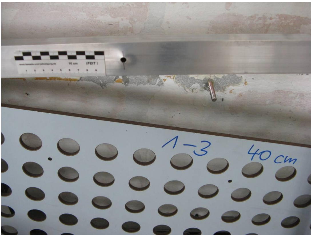
Bild 12: Versagen Niet; abgeprüfter Versuchskörper 1-3
