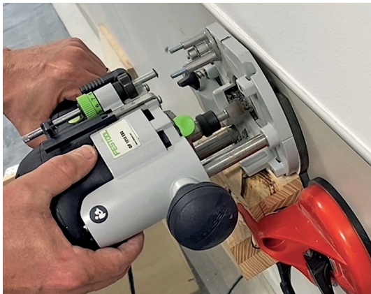
Oberfräse für das bauseitige Ansetzen von zusätzlichen Befestigungspunkten
