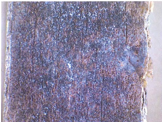
Abb. 4: Risse in der Schnittkante
